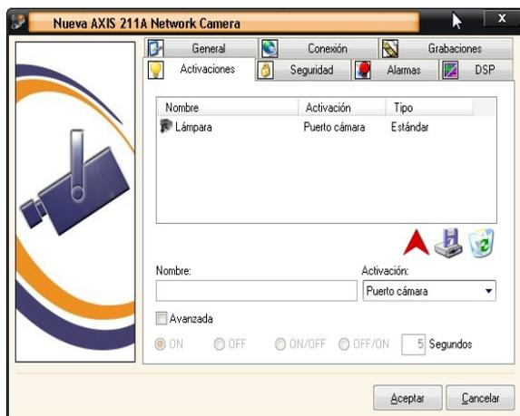
Los dispositivos conectados a la cámara podrán ser activados y desactivados a través de la pantalla de visualización de la misma.
