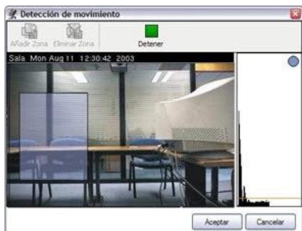
Figura 9. Configuración Detección movimiento
