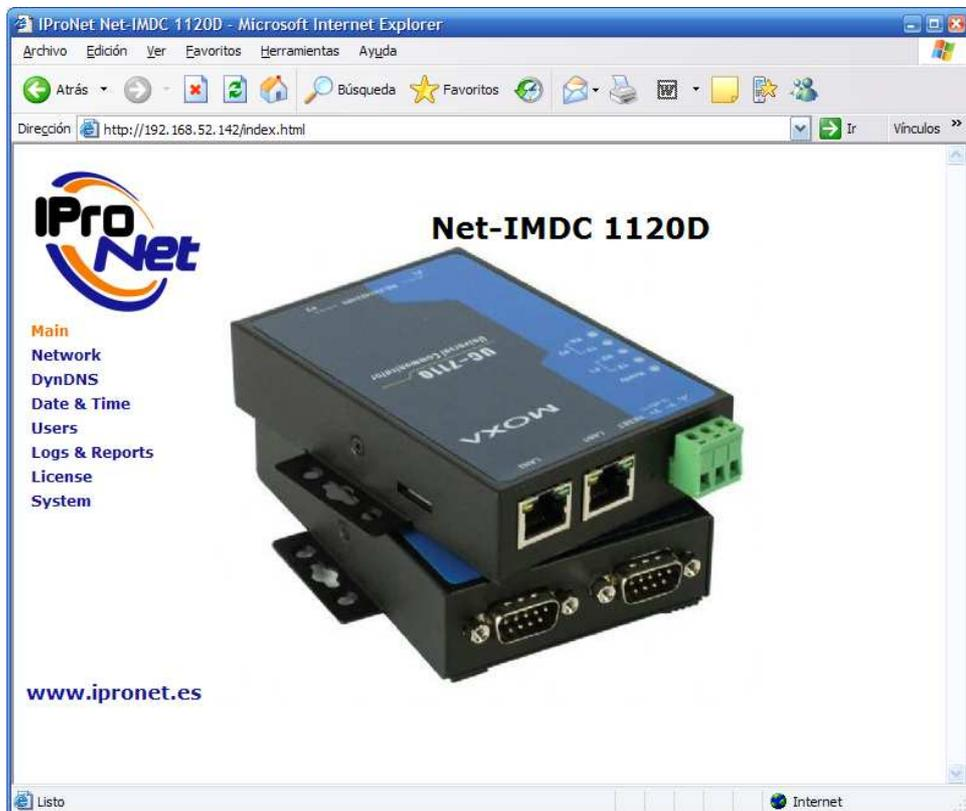
El acceso al servidor web del dispositivo Net-IMDC se realiza una vez conectado a la red el mismo, iniciando una ventana del navegador. En esta ventana se introducirá la dirección IP con la que se suministra el dispositivo por defecto: 192.168.3.127
