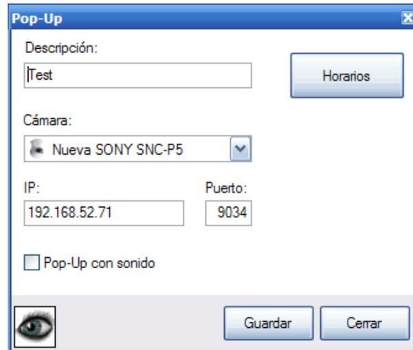
Se indicará al sistema la cámara que se desea mostrar en la pantalla de alarmas del operador remoto (ver manual e-netcamCLIENT, sección Alarmas) y la dirección IP del equipo en el que se encuentra instalado el sistema antes indicado, que será el puesto del operador, así como el puerto por el que ese sistema estará “escuchando” la llegada de mensajes emergentes a su máquina.
